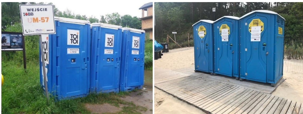
Fot. 33. Nieprawidłowe ustawienie toalet: brak wygodnego, utwardzonego dojścia (po lewej)
